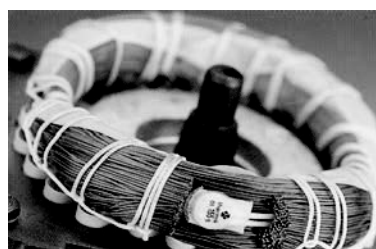
Рис. 28 Термовыключатель, встроенный в обмотку электродвигателя
