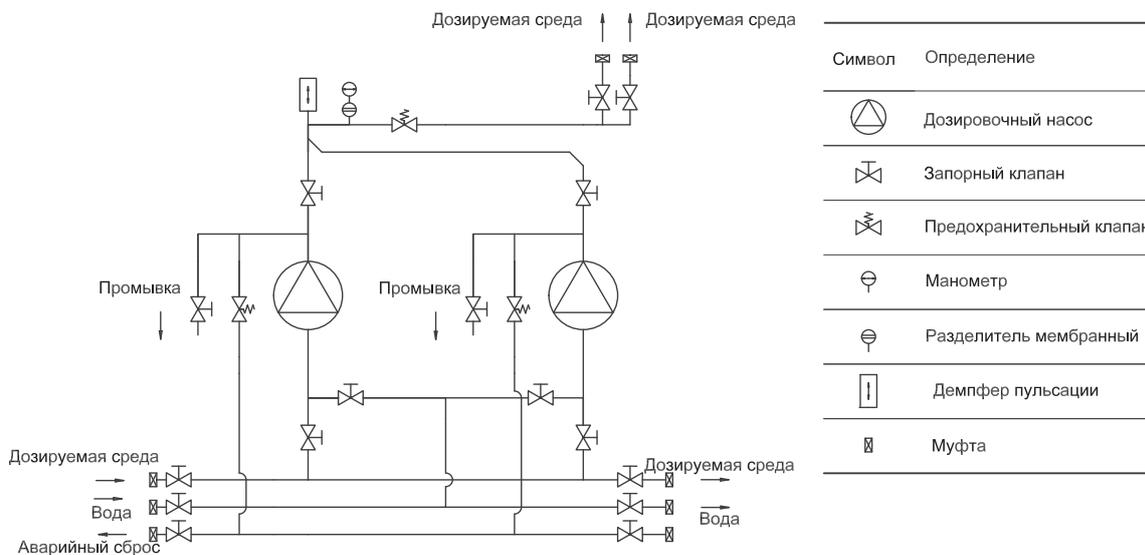
Рис. 1 Вариант исполнения С: один рабочий насос/один резервный
