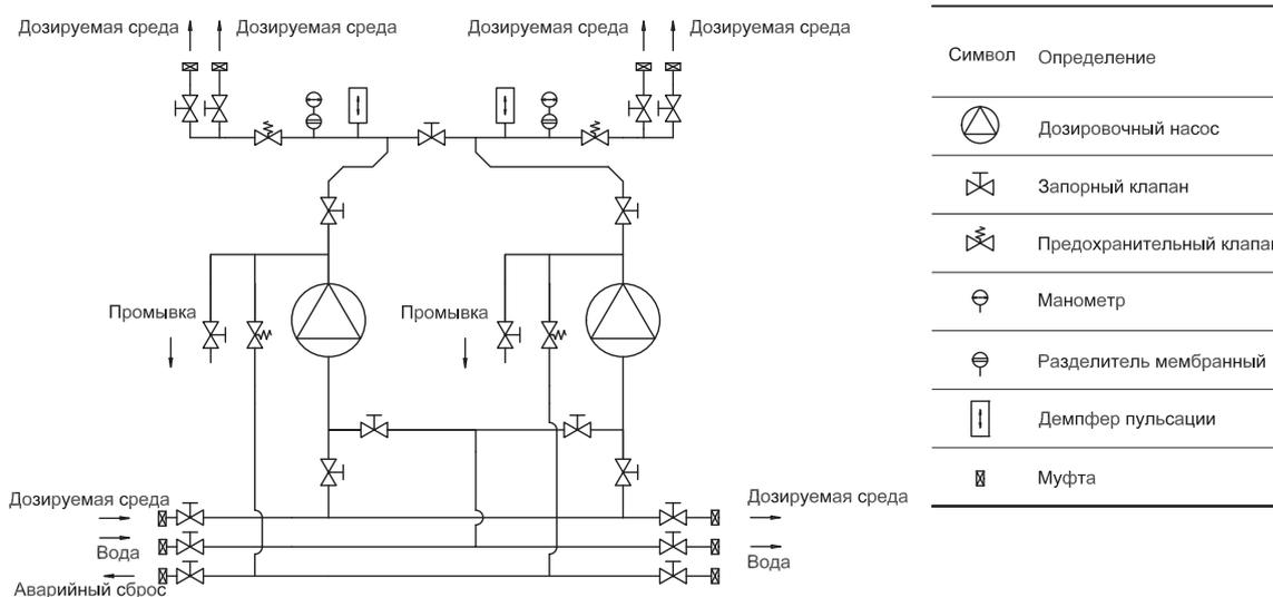
Рис. 2 Вариант исполнения В: два рабочих насоса
