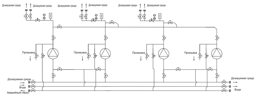
Рис. 4 Вариант исполнения E: три рабочих насоса/один резервный
