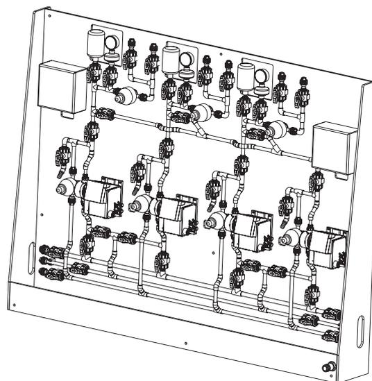
Рис. 8 Дозировочная установка DSS с тремя рабочими и одним резервным насосами\* (компоновка E)
